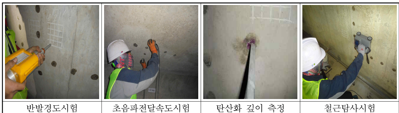
【사진 3.4.1】 콘크리트 내구성조사 전경
